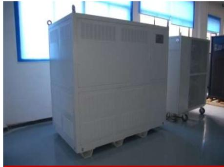
Anti-Islanding 테스트 장치
